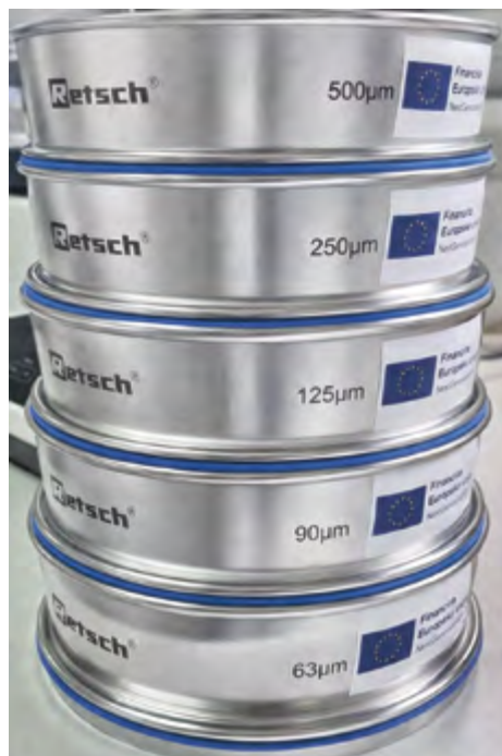
Komplet sita za šlemanje (Retsch), projekt RAMPA (foto: A. ČAIĆ JANKOVIĆ) Sieve set (Retsch), RAMPA project (photo: A. ČAIĆ JANKOVIĆ)
