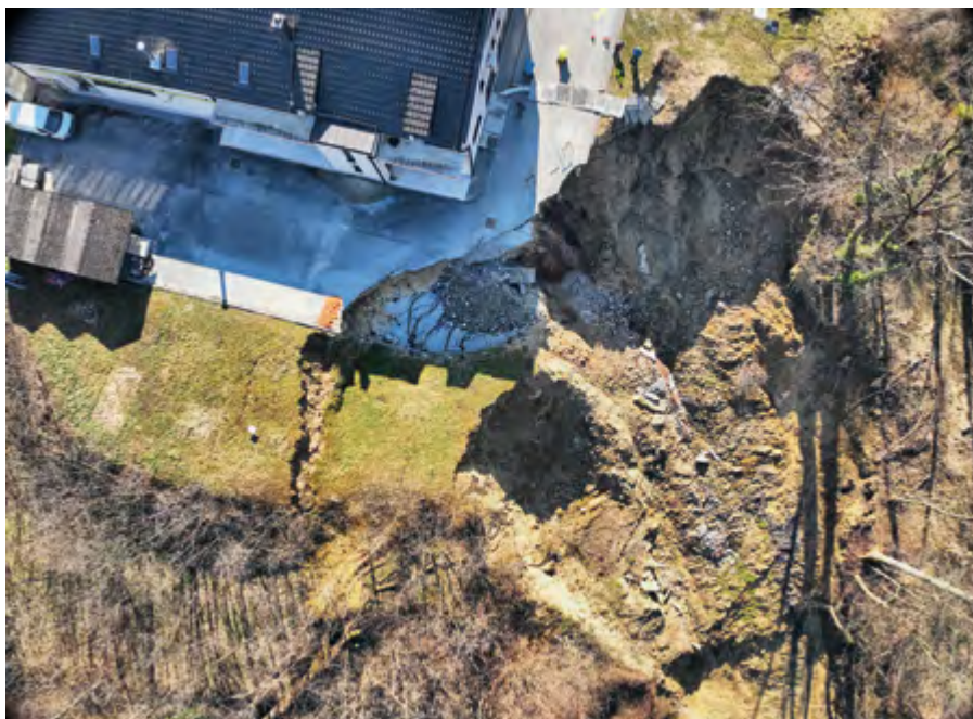
Snimanje klizišta Hum na Sutli bespilotnom letjelicom DJI Matrice 350 (foto: T. FRANGEN) UAV (DJI Matrice 350) survey of the Hum na Sutli landslide (photo: T. FRANGEN)
