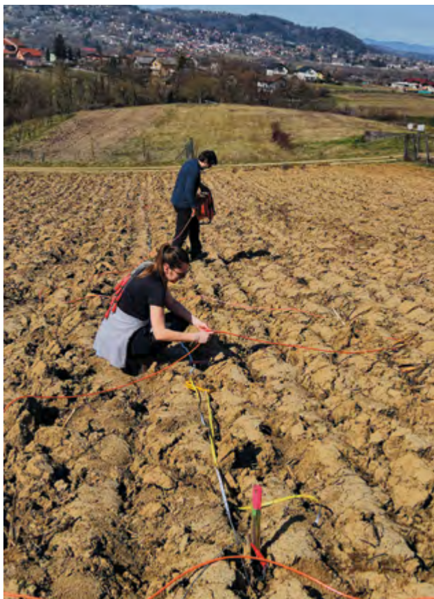
ERT – postavljanje elektroda (foto: J. MASLAČ SOLDÓ) ERT – electrode installation (photo: J. MASLAČ SOLDÓ)
