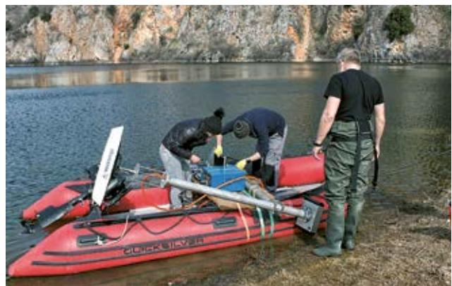
Odašiljač geološkog dubinomjera (Innomar Compact) s GPS antenom, postavljen na donji dio nosača na motorno plovilo u jezeru u Prološkom blatu
