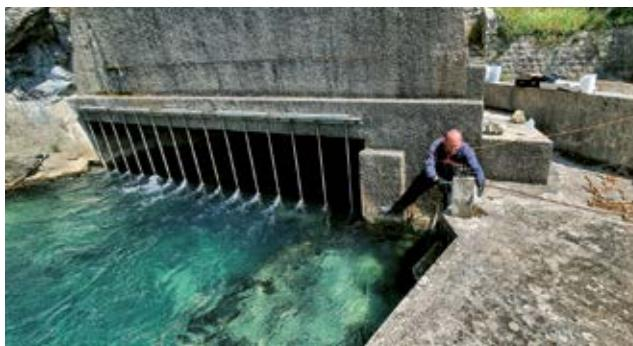
Postavljanje automatskog mjerača za temperaturu i elektrolitičku vodljivost u izvor Jadro
