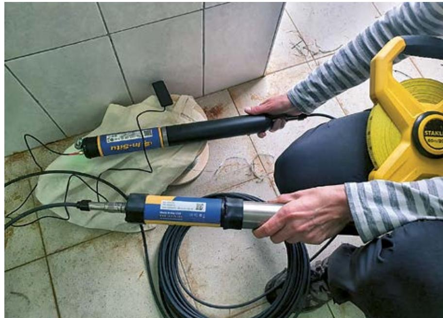
Postavljanje multiparametarskog automatskog mjerača Aqua Troll 500 tvrtke In situ s telemetrijskim očitanjem u najvažnijem vodoopskrbnom zdencu Studenac
