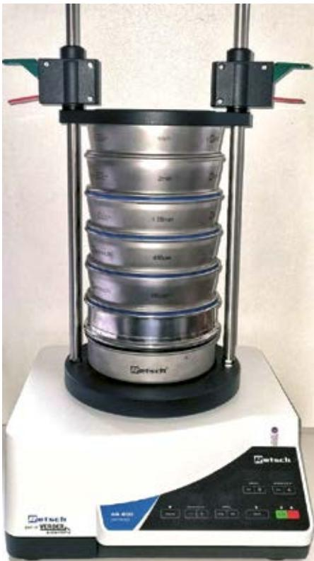
Uređaj za trešenje sita AS200 control sa setom sita proizvođača Retsch (foto: A. Čaić Janković)
