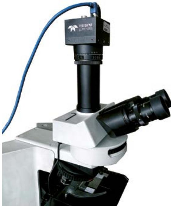
Teledyne Lumenera kamera s pripadajućim Microvisioneer WSI programskim paketom i licencama koja se koristi za mikrofotografiranje dijelova i skeniranje cijelih mikroskopskih preparata. (foto: V. Brčić)
