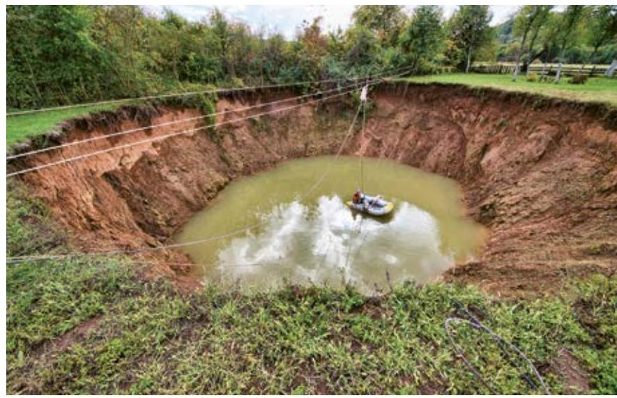
Mjerenje dimenzija urušne vrtače nastale nakon potresa na Banovini (foto T. Frangen)
