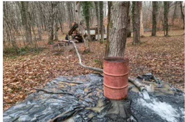
Hidrodinamička mjerenja na aktivnoj geotermalnoj bušotini TEB-4 u Topuskom (lijevo) te pokusno crpljenje na neaktivnoj geotermalnoj bušotini Dar-1 u Daruvaru (desno) sklopu projekta HyTheC (foto M. Pola)
