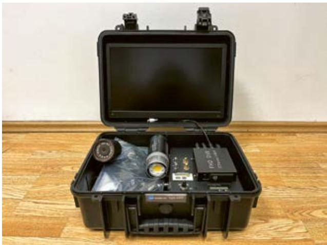
Podvodna kamera Mangrove Explorer EX-FHD-FS-1D s rasvjetom i upravljačkim sustavom, predviđena za korištenje na dubinama do 200 m (foto M. Budić)
