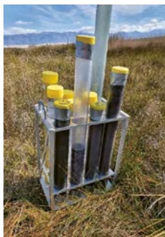
**Uzorkovanje pomoću gravitacijskog jezgrila s klipnog korera s gumenjaka (lijevo) te izvađene kratke jezgre sedimenata (desno)**
