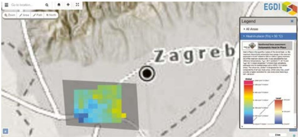
Prikaz osnovne geotermijske procjene „topline na lokaciji“ za Zagrebački geotermalni vodonosnik izrađene u sklopu projekta HotLime (iz EGDI-ja)
