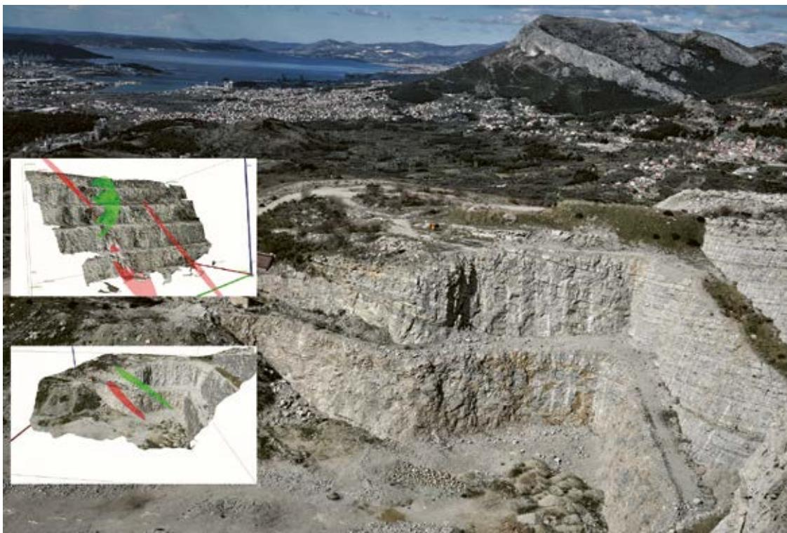
Korištenje ShapeMetrix3D sustava za inženjerskogeološku analizu podataka dobivenih terestričkom digitalnom fotogrametrijom u kamenolomu Klis-Kosa na Mosoru (foto D. Navratil)
