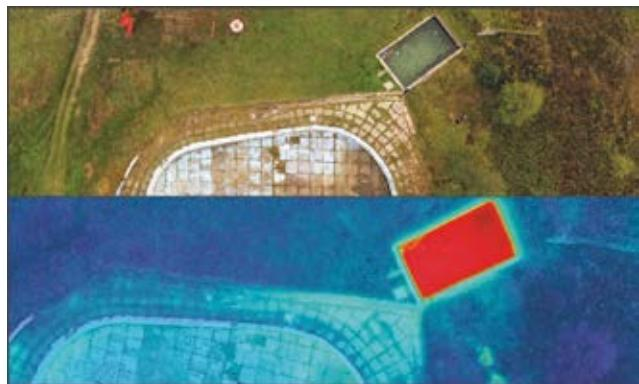
Snimka Šemničkih toplica bespilotnom letjelicom u vidljivom i infracrvenom spektru
