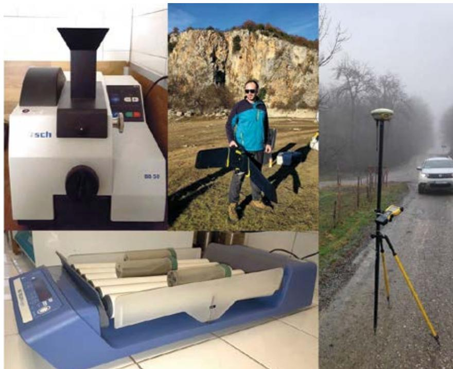
Novi laboratorijski uređaji Zavoda za geologiju: mlin drobilica i tresilica te bespilotna letjelica i GNSS stanica (foto: A. Čaić Janković i B. Kordić)
