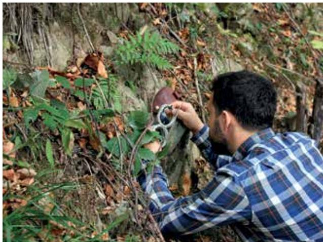
Mjerenje strukturnih elemenata u sklopu provođenja temeljnih geoloških istraživanja za projekt izgradnje nove žičare na Medvednici, Zagreb (foto M. Budić)
