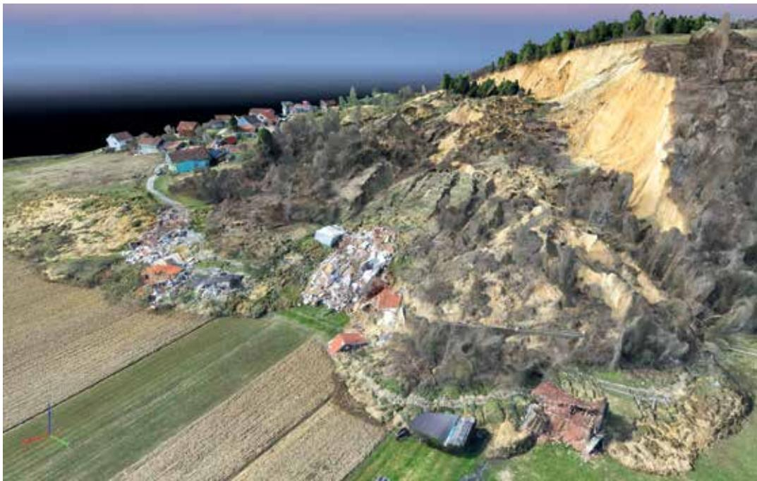
Model klizišta u Hrvatskoj Kostajnici izrađen iz snimki bespilotnom letjelicom Sensefly eBee Plus
