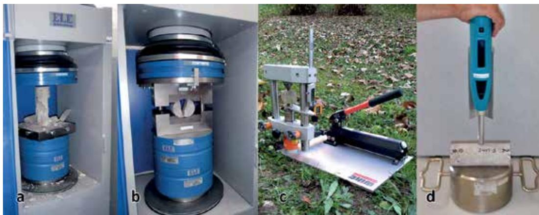
Hidraulična preša (a,b), uređaj za određivanje čvrstoće u točki (c) i Schmidtov čekić (d)
