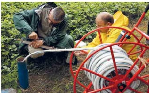
**Uzorkovanje podzemne vode za određivanje koncentracija plemenitih plinova**
