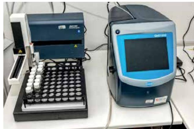
TOC analizator (uređaj za mjerjenje TOC, DOC, TIC i DIC u vodi s automatskim uzorkivačem)
