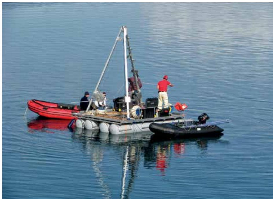
Istraživačka platforma „Q2”, s klipnim jezgrilom koje omogućuje uzorkovanje slijeda nekonsolidiranih jezerskih i morskih sedimenata (foto Ž. Dedić)
