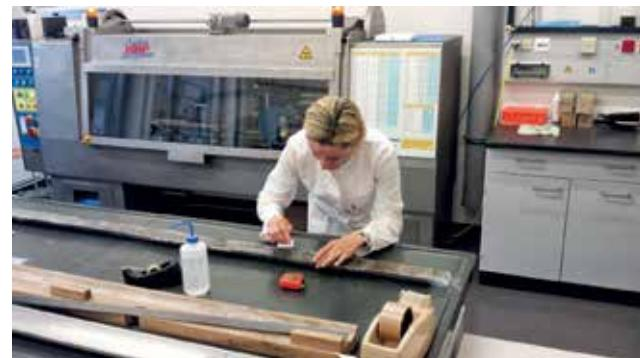
Analiza geokemijskog sastava jezgri sedimenata pomoću XRF-a (core scanner) u MARUM centru u Bremenu (foto I. Razum)
