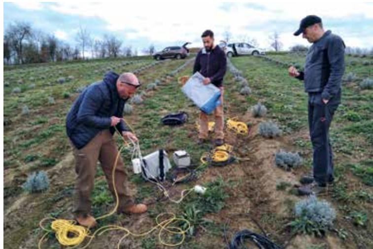
Magnetotelurika – priprema za akviziciju podataka na udaljenoj referentnoj točki
