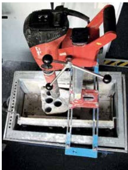
**Bušilica za cilindrične uzorke u laboratoriju**
