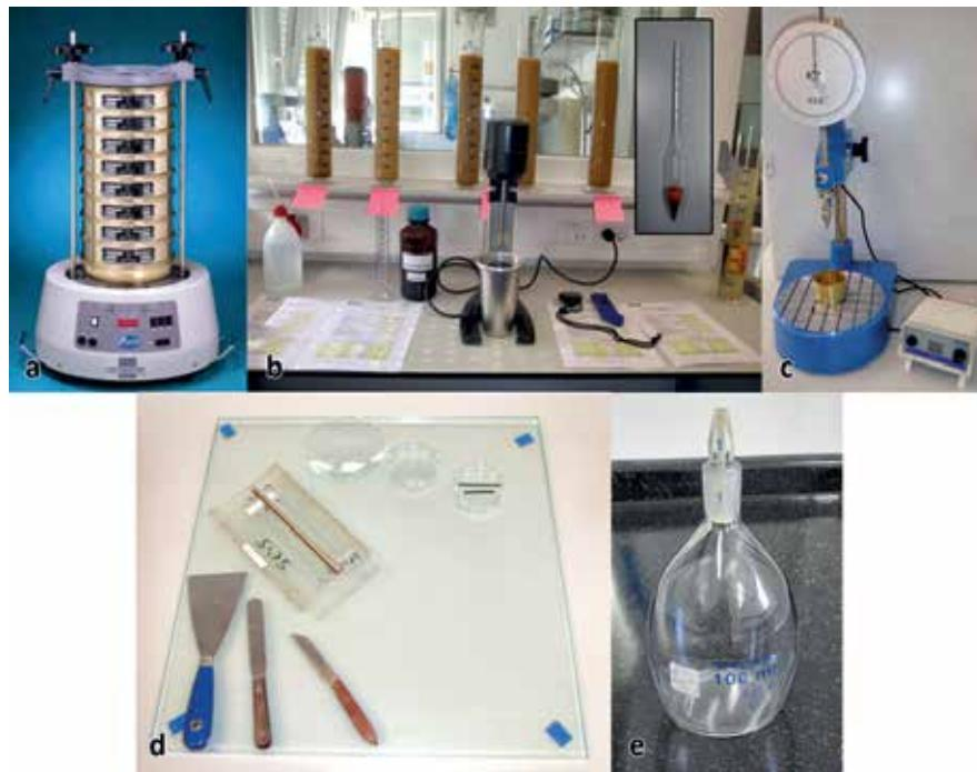
Određivanje granulometrijskog sastava suhim sijanjem (a), određivanje granulometrijskog sastava areometriranjem (b), određivanje granice tečenja konusnim penetrometrom (c), određivanje granice plastičnosti (d) i određivanje gustoće čvrstih čestica (e)
