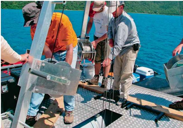
Bušenje jezerskih sedimenata izvedeno pomoću platforme i klipnog korera na Vranskom jezeru na Cresu • Drilling lake sediment carried from the platform equipped with the piston corer at the Vransko jezero at the island of Cres.
