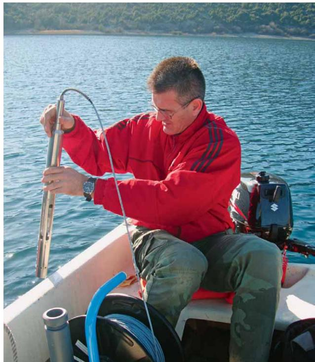
Mjerenje fizikalno-kemijskih svojstava vode u Vranskom jezeru na otoku Cresu • Measurement of physical-chemical properties of water in Lake Vrana on the island of Cres.
