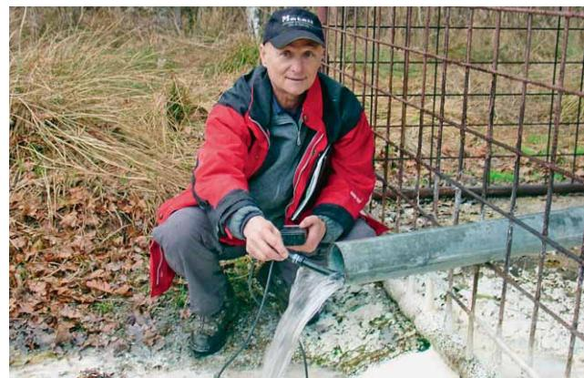
Mjerenje fizičko-kemijskih parametara geotermalne vode iz bušotine na Popović brdu • Measurement of the physico-chemical parameters of geothermal water from the well on the Popović brdo.
