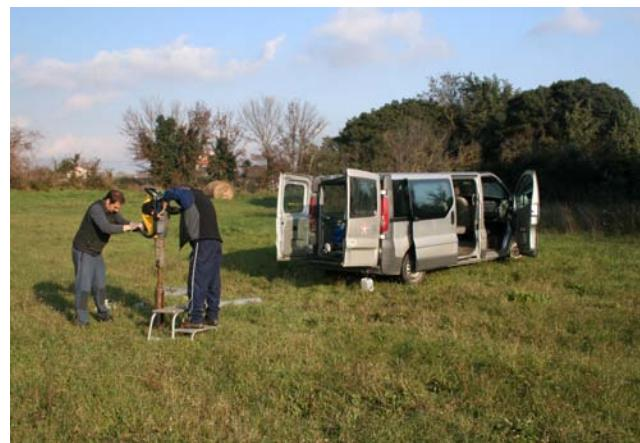
Izrada bušotina za određivanje debljine i ispitivanje vodopropusnosti pokrovnih naslaga
