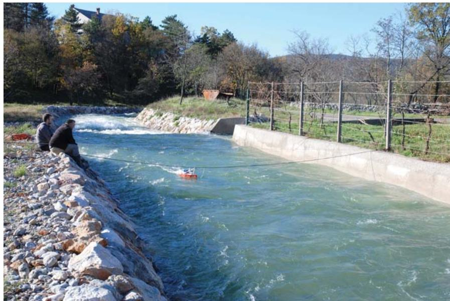
Mjerenje protoka na povremenom vodotoku Sušica na Grobničkom polju.
