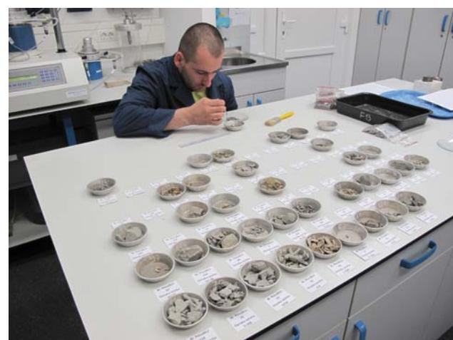
Određivanje postojanosti uzoraka laporanja.
