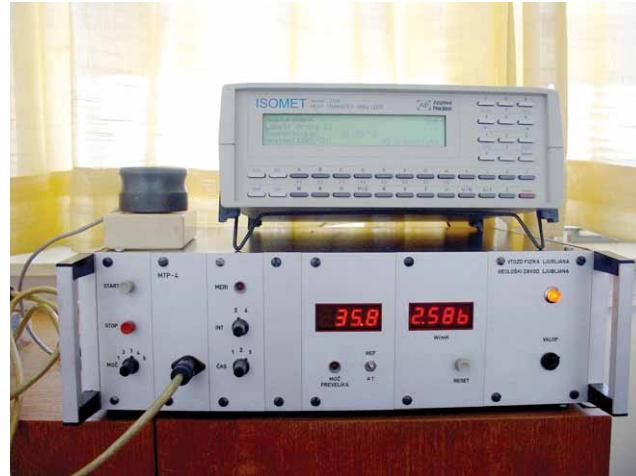
Mjerenje koeficijenta toplinske provodljivosti, volumnog toplinskog kapaciteta i toplinske difuznosti uzoraka stijena.
