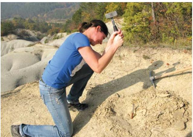
Istraživanje trošenja i erozije na ogolinama u Istri: postavljanje geodetskih signala za potrebe snimanja bespilotnom letjelicom – dronom
